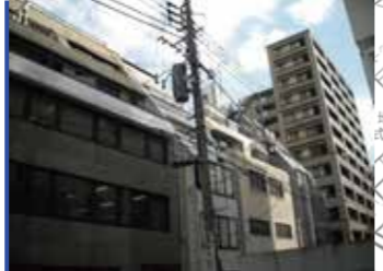
高さ制限（道路斜線制限）の緩和による土地有効利用のイメージ …写真左側が道路斜線制限を受けた建築物、右側が制限緩和により有効利用された建築物
