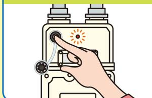
4 約3分待つ。(この間にマイコンが安全を確認。)赤ランプの点滅が消えるとガスを使えます。
